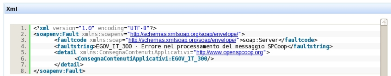
Figure3.35: Dettaglio di un errore applicativo (fault)
